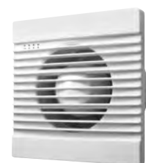
FBS300 Wentylator ścienny Ø rury 100 mm 230 V, 15 W, 50 Hz, z zaworem zwrotnym ABS plastik/biały
