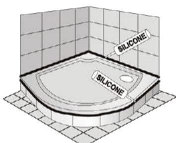
eingebaut und gefliest
