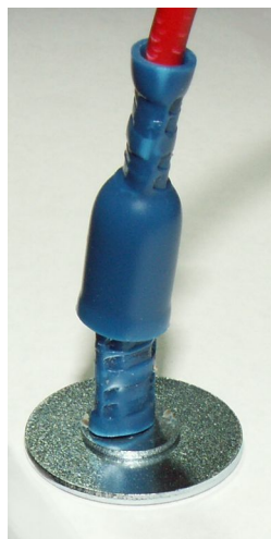
Obr.1 - Detail zavěšení a napojení napájecího kabelu.
