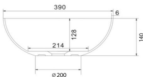
FORMIGO Betonwaschbecken zum Aufsetzen mit
