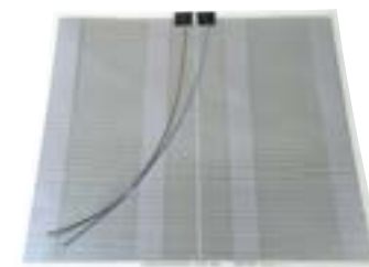
Vyhřívaná fólie proti zamlžení zrcadla, 400x400 mm aktivace po zapnutí osvětlení 230 V/36 W
