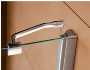
Profil ścienny umożliwia regulację do 20 mm. Przydatny przy nierównych ścianach.
