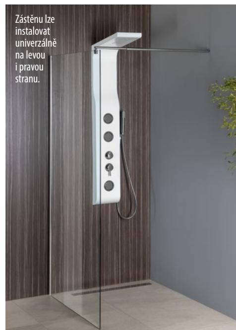
WALK-IN jednodílná pevná zástěna k instalaci na zeď profil chrom, čiré sklo 6 mm, výška 190 cm součástí balení je teleskopická vzpěra 70–120 cm
